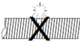
管面破裂
